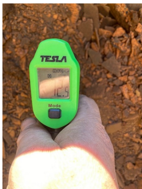
Экзотермический процесс окисления Fe^{2+} на воздухе (температура саморазогрева 72C )
