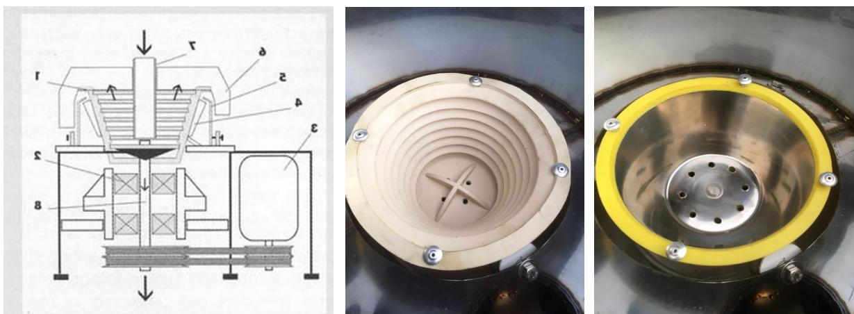
Рис.1. Принципиальная схема центробежного концентратора с плавающей постелью
